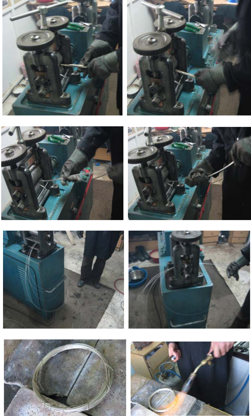
Şekil 4.46 Tel çekme makinasında gümüş çubuğun inceltilmesi
