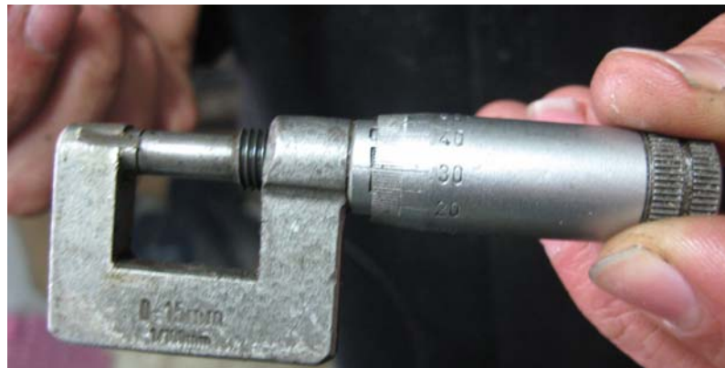
Şekil 4.49 Telin kalınlığının mikrometre yardımı ile ölçülebilmesi
