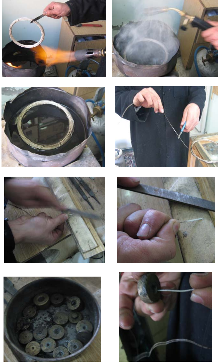
Şekil 4.47 Telin haddeden geçirilmeye hazırlanması
